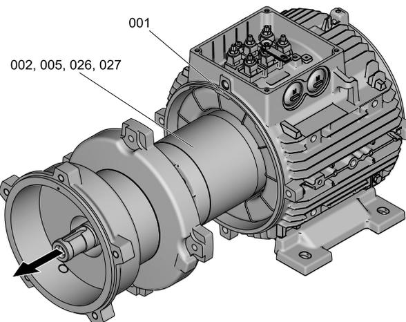
*Disassembling the rotor*
