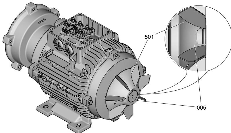
*Fitting the fan impeller*
